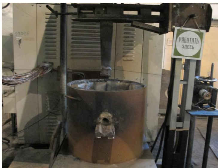
Сурет 4.2 – Қуаттылығы 150 кВА электрдоғалы пеші
