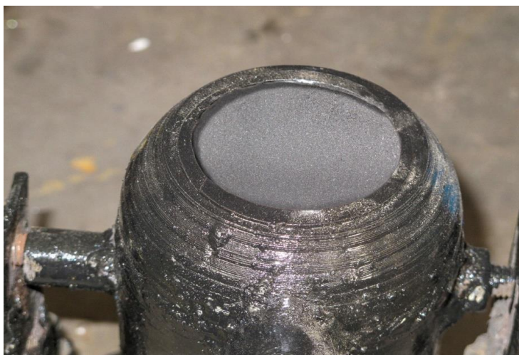
Сурет 4.3 – Ішкі отқа төзімді қаптауы бар конвертер моделі
